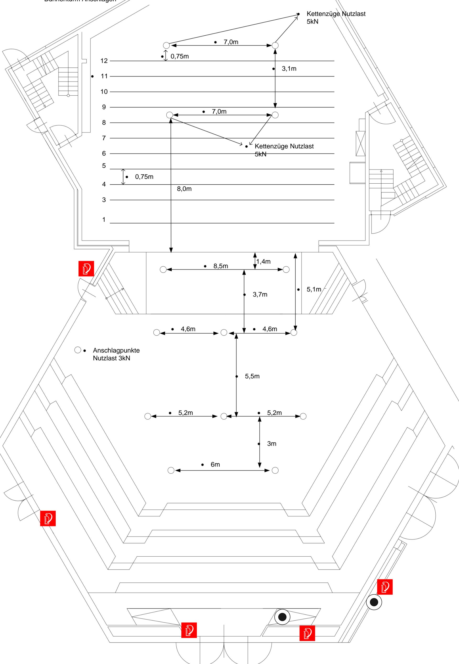
○ • Anschlagpunkte Nutzlast 3kN
